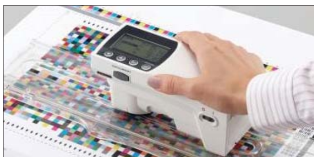
Narzędzie wykorzystane do pomiaru barwy to spektrodensytmetr FD-7 firmy Konica-Minolta
